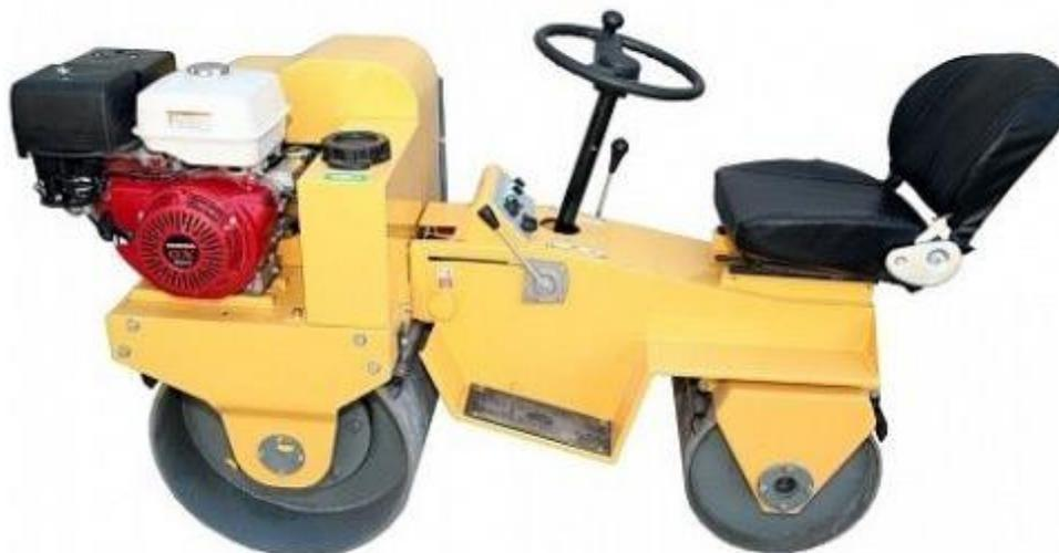
Двухвальцовый вибрационный каток AZTEC KB2-700 применяется для уплотнения всех видов почв и асфальтобетонных смесей. Незаменим в работе по укладке и ремонту покрытий спортивных и игровых площадок, пешеходных дорожек, тротуаров.
