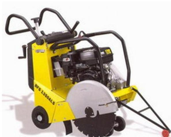
Резчик швов бензиновый AZTEC РБ 450 ХР предназначен для резки асфальтового и бетонного покрытия и применяется при строительных, ремонтных и ландшафтных работах. Агрегат представляет собой тележку, на которой установлен бензиновый двигатель, через ременную передачу приводящий в движение режущий диск. Тележка установлена на колесах, оборудована удобными ручками и указателем направления резания. Диск охлаждается водой, поступающей через штуцер из установленного на тележке бака.
